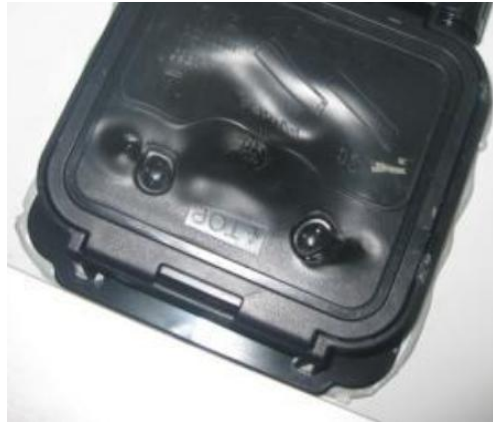
图6 光伏组件接线盒变形
