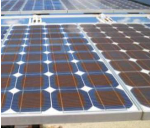
图5 光伏组件封装材料变色
